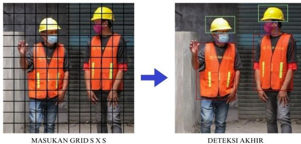
Gambar 2. Ilustrasi cara kerja algoritma YOLO
