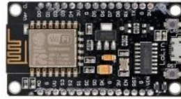
Gambar 2.1. Modul NodeMCU serial ESP8266 [6]
