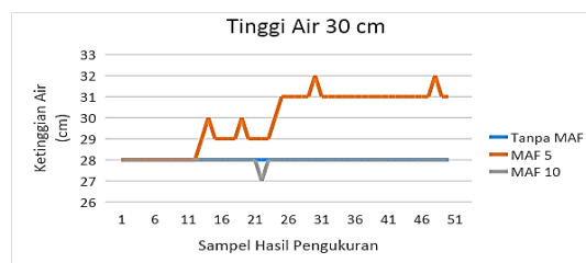
Gambar 4.1. Grafik Hasil Pengujian Sensor JSN-SR04T Pada Tinggi 30 cm
