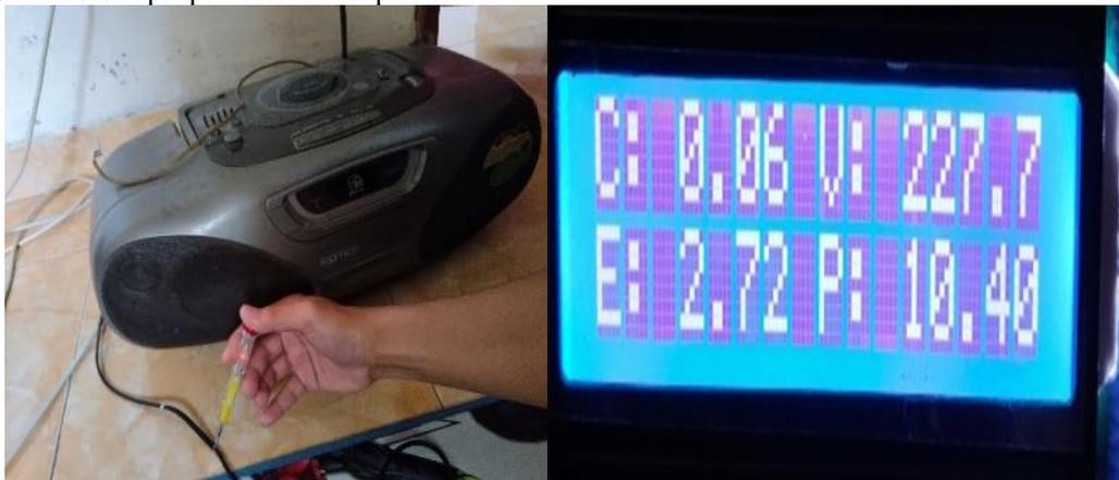
Gambar 3.3 Pengukuran Arus Bocor Pada Radio
