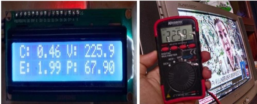
Gambar 3.4 Perbandingan Nilai Tegangan LCD Dengan Alat Ukur Multimeter Pada Televisi
