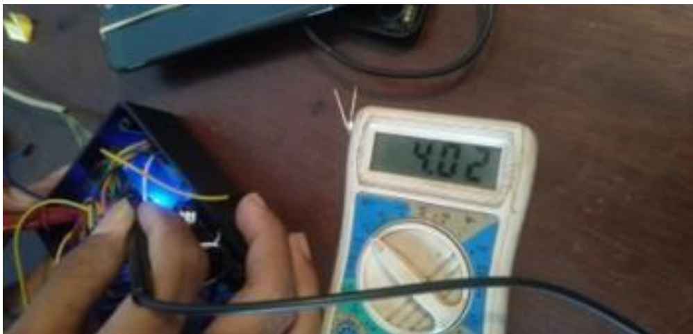
Gambar 4.1 Pengukuran Tegangan Mikrokontroler
